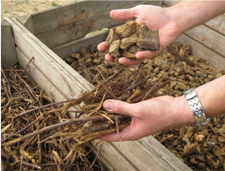
Bild 4-20 Holzhackschnitzel aus Schnittholz (links) und Wurzelholz (rechts) (Photo: Schulz)
